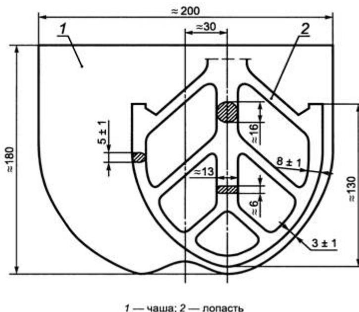
Рисунок 1 - Смеситель для приготовления растворных и мелкозернистых бетонных смесей
