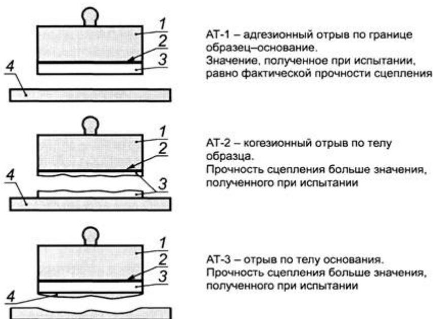
1 - металлический штамп; 2 - клей; 3 - образец; 4 - бетонная плита (основание)
